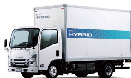
ディーゼルエンジンと、電気モーターを組み合わせたハイブリットのトラック
