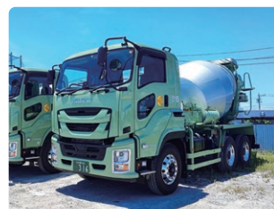
固まっていないやわらかいコンクリートを工事現場へ運ぶトラック
