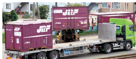
鉄道で運ばれてきたコンテナをトラックに積み替えているところ
