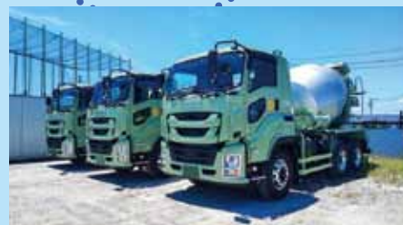
●生コンクリートを運ぶコンクリートミキサー車
