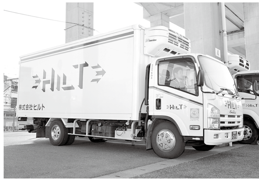
管理温度の異なる荷物を輸送できる2室式コンテナを採用した同社のトラック
