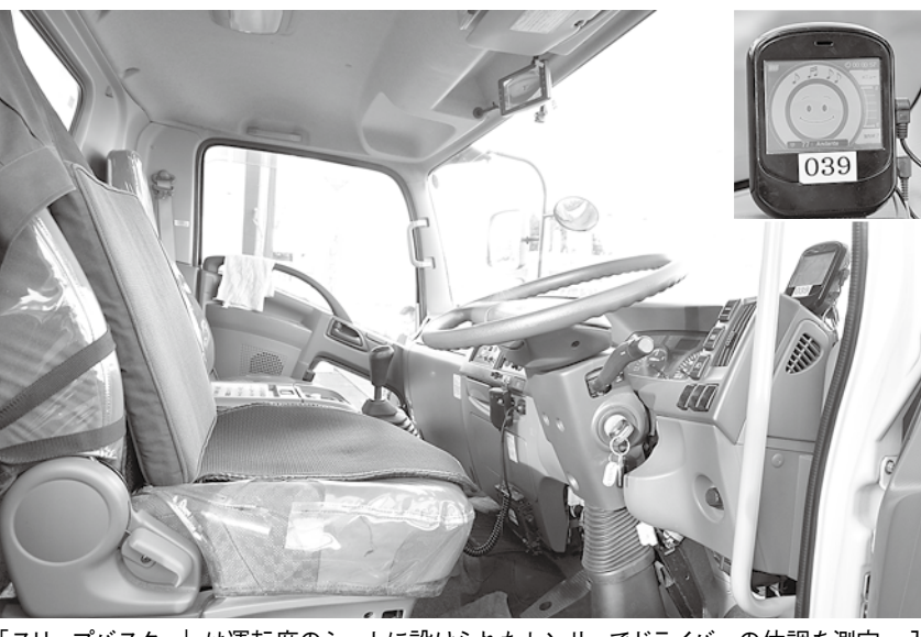
「スリーパスター」は運転席のシートに設けられたセンサーでドライバーの体調を測定。入眠予兆現象発生時にはモニター④が警告する
