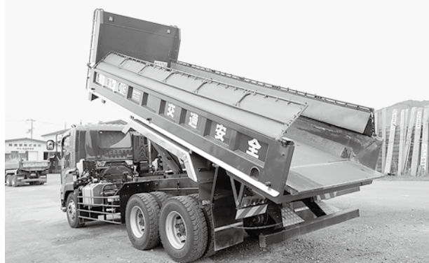
ダンプの荷台には貨物凍結防止の荷台底面を暖房する装置が装着されている
