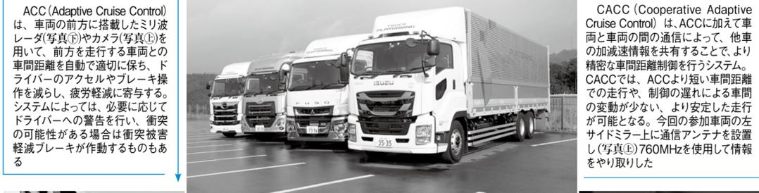
ACC (Adaptive Cruise Control) は、車両の前方に搭載したミリ波レーダ(写真①)やカメラ(写真②)を用いて、前方を走行する車両との車間距離を自動で適切に保ち、ドライバーのアクセルやブレーキ操作を減らし、疲労軽減に寄与する。システムによっては、必要に応じてドライバーへの警告を行い、衝突の可能性のある場合は衝突被害軽減ブレーキが作動するものもある。
