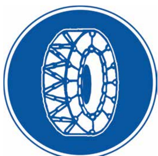
「タイヤチェーンを取り付けていない車両通行止め」の規制標識:新設
