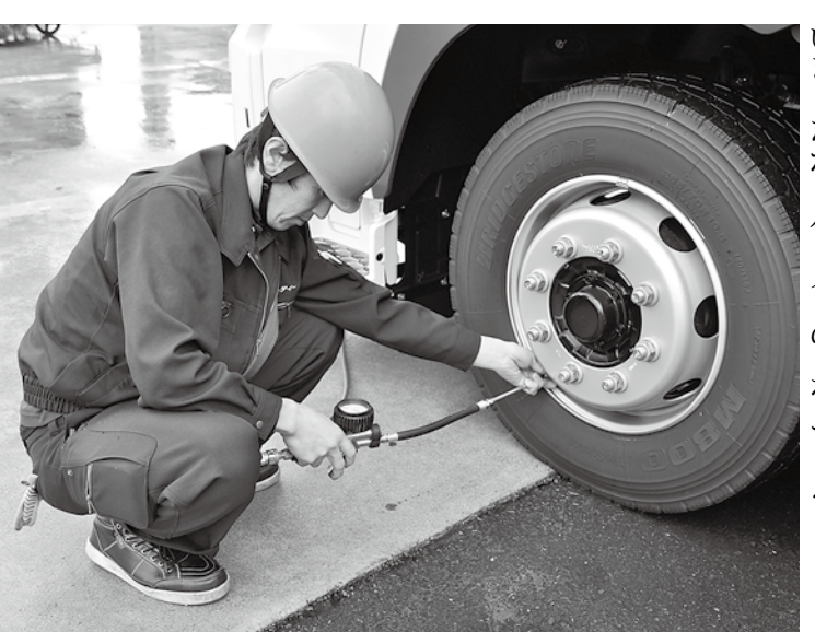
運行前点検の際にはエアゲージを用いてタイヤの空気圧をチェックする
