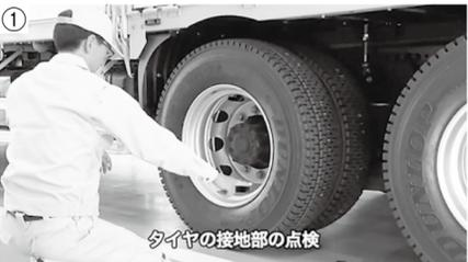
タイヤの点検は、接地部のたわみの状態により空気圧が不足していないかを点検します(写真①)。
