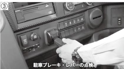
ホイールパーク式の場合は、エンジンをかけて、規定の空気圧の状態ではレバーを駐車位置まで引いた時、レバーが固定され、空気の排出音が聞こえるかどうかを点検します(写真③)。
