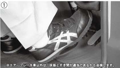
ブレーキ・ペダルは、エンジンをかけた状態で、ブレーキ・ペダルをいっぱい踏み込んだ時、床板との隙間や踏みこたえが適切であるか、マットや異物のかみ込みがないかを点検します(写真①)。
