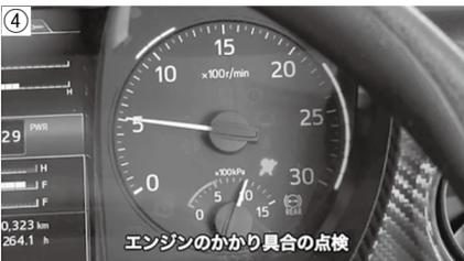
速やかに始動し、スムーズに回転するかを点検します(写真④)。エンジン始動時、およびアイドリング状態で異音がないかも点検します。また、エンジンを暖機させた状態で、アイドリング時の回転がスムーズに続くかを点検します。
