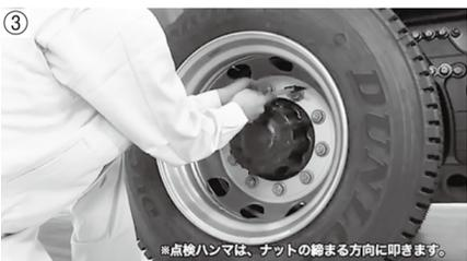
ホイール・ナットの脱落、ホイール・ボルトの折損など異状がないか、ホイール・ボルト付近にさび汁が出た痕跡はないか、ホイール・ナットから突出しているホイール・ボルトの長さに不揃いはないかなど点検ハンマなどで点検します(写真③)。
