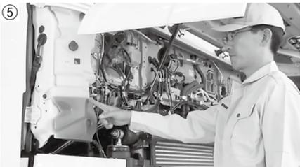
ラジエーターなどの冷却装置は、リザーバ・タンク内の冷却水の量が規定の範囲にあるかを点検します(写真⑤)。
