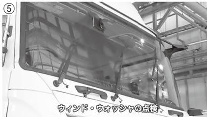
ウィンド・ウォッシャは、液の噴射向きなどが適切かどうかを点検します。また、ワイパーを作動させ、間欠、低速、および高速の各作動が不良でないかを点検します。きれいに拭き取れるかも点検します(写真⑤)。
