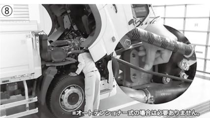
ファン・ベルトは、ベルトの中央部を指で押し、ベルトが少したわむ程度であるかを点検します。さらに、ベルトに損傷がないかを点検します(写真⑧)。
