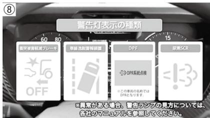
最近のトラックには、安全および環境に配慮した装置が搭載されています。異常がある場合は警告ランプ(写真⑧)が点滅あるいは点灯しますので、各社のマニュアルを参照してください。
