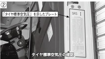
タイヤ標準空気圧は、必ず車両に貼り付けられたプレート(写真②)で確認してください。
