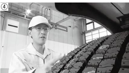
タイヤの全周について、著しい亀裂や損傷がないかを点検します。くぎ、石、その他の異物が刺さったりかみ込んだりしていないかも点検します(写真④)。タイヤの接地面が異常に摩耗していないかを点検します。
