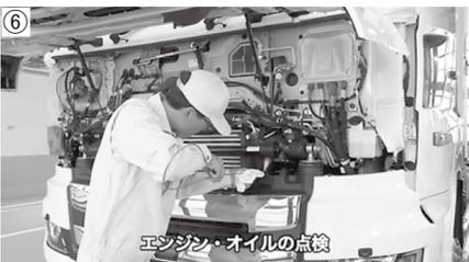
エンジン・オイルの量が、オイルレベルゲージに示された範囲内にあるかを点検します(写真⑥)。
