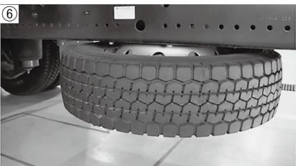
スペアタイヤの点検項目に関しては、法令改正により平成30年10月1日から、5面「日常点検の手順例」※2で示した内容が3か月ごとの定期点検項目に追加されています(車両総重量8t以上の自動車に限る)(写真⑥)。
