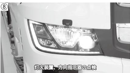
灯火装置、方向指示器は、エンジンスイッチを入れ、前照灯、制動灯などの灯火装置の点灯具合や、方向指示器の点滅具合が不良でないかを点検します(写真⑧)。レンズや反射器に汚れや変色、損傷がないかも点検します。
