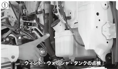
ウインド・ウォッシャー・タンクは、タンク内の液量が適当かを点検します(写真①)。
