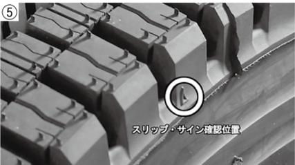
溝の深さに不足がないかをスリップ・サインなどで点検します(高速道路を走行する場合、大型トラック用タイヤは残溝3・2mm以上、小型トラック用タイヤは残溝2・4mm以上)(写真⑤)。
