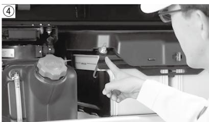
バッテリーは、各槽の液量が規定の範囲内にあるかを点検します。バッテリーの液量は、バッテリーケース内の液面がケース側面の「UPPER」と「LOWER」の間であれば適正です(写真④)。
