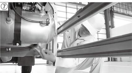
エア・ブレーキが装着されている場合は、ドレンコックを開いて、エアタンクに水がたまっていないかを点検します(写真⑦)。水が多量に出てくる時は、エア・ドライヤーの点検も必要です。
