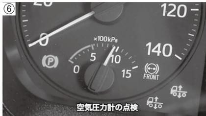
空気圧力計は、エンジンをかけて、空気圧の上がり具合が極端に遅くないかを点検します。また、空気圧力が空気圧力計に表示された範囲にあるかを点検します(写真⑥)。
