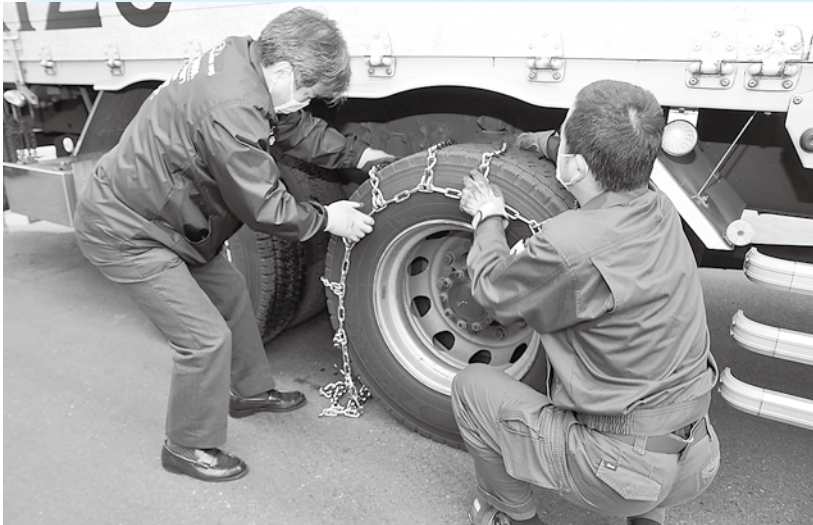
同社のドライバー⑥がタイヤチェーンメーカーの担当者⑤の指導を受けながら、チェーンの装着法を学ぶ
