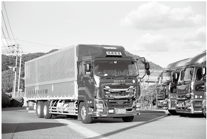
同社主力の大型25トン車は、助手席を省いたり、燃料タンクを300リットル一つにするなどの軽量化対策がとられている
