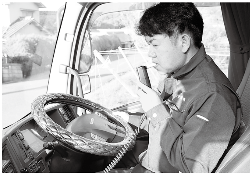
運転席でエンジンを始動するためには、まず、アルコールインターロックで飲酒検知器に呼吸を吹きかけ、アルコールが検知されないことが必要
