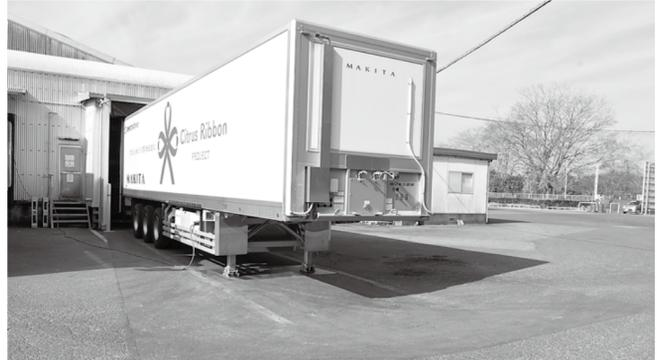
トレーラを接車した時に傾斜があるとトレーラの奥まで積み付けには労力が必要になるため、傾斜を削ってトレーラが水平になるように改善を行った(宮崎県都城市の宮崎くみあいチキンフーズ(株)の食品工場)
