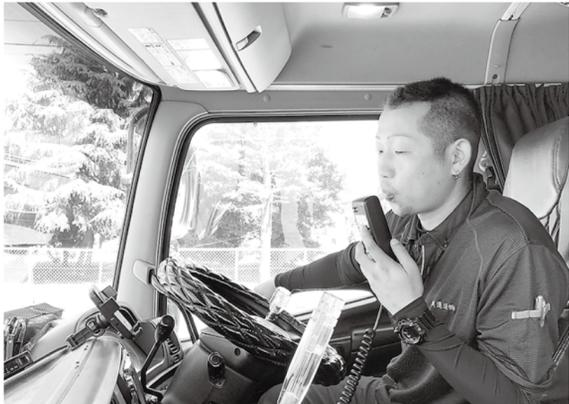
同社で導入しているアルコールインターロック装置には、運行中にも測定可能な機能も搭載されている
