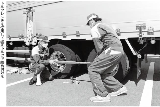
トルレンチを使用して適正トルクで締め付けを
