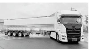
同社では飼料用バルク車としてセミトレーラを導入している
