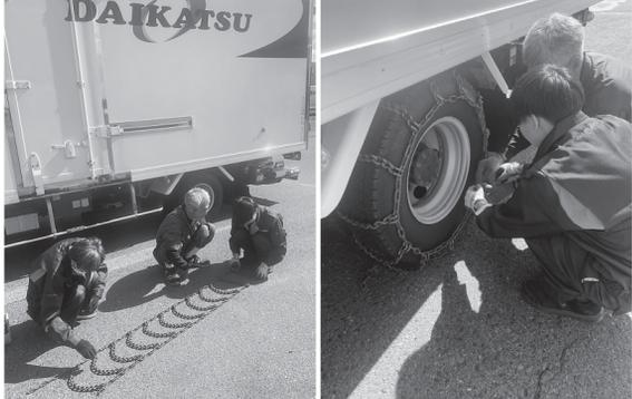
チェーン装着教育では、緊急の場合を想定した上で、実際にドライバーにチェーンを装着させる(写真⑤)。また、チェーンの種類や構造についても指導を行う(写真⑥)
