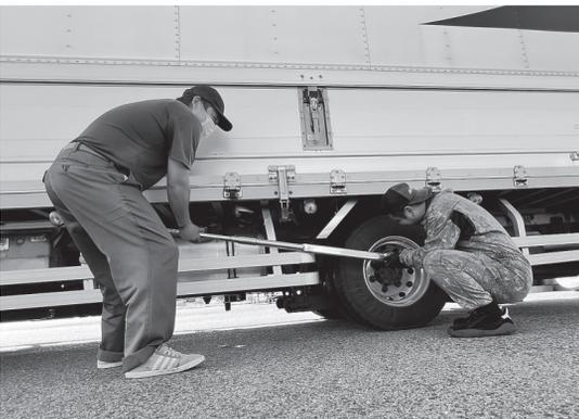
タイヤ交換作業直後の運行後には増し締めを実施しているほか、ドライバーがトルクレンチによる増し締めを行い、車輪脱落事故を未然に防いでいる
