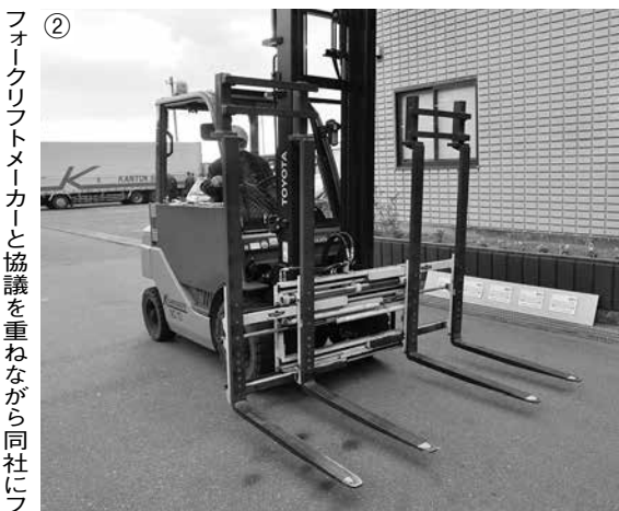
フォークリフトメーカーと協議を重ねながら同社にフィットする形に開発した枚差しフォークリフト
