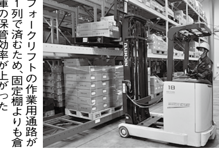
フォークリフトの作業用通路が1列で済むため、固定棚よりも倉庫の保管効率が上がった
