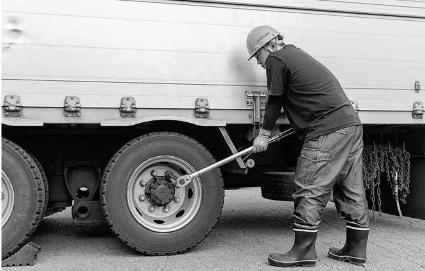
同社では毎月最初にドライバーがトルク・レンチによる増し締めを行い、車輪脱落に繋がるホイール・ナットの緩みを未然に防いでいる
