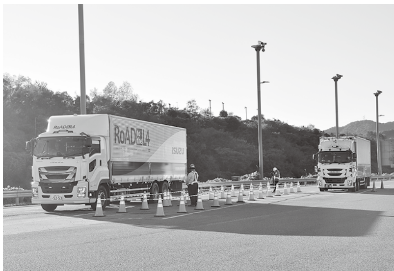
6年12月4日に新東名浜松SAで実施された自動運転トラックの要素技術検証の現場公開では、自動運転で走行してきた自動運転トラックが自動で駐車マスを停車した
