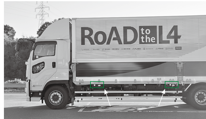
要素技術検証に使用された大型トラックには、周囲を走行する一般車両のドライバーへの周知を図るため、自動運転ランプ(白矢印)を設置した
