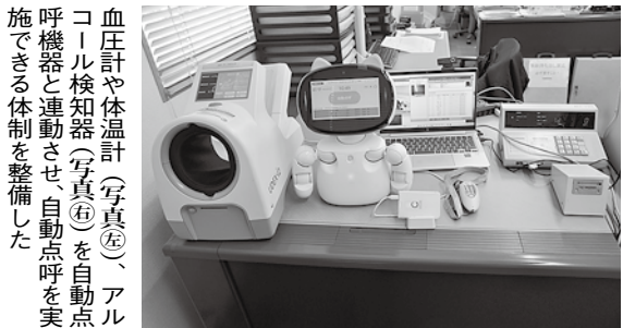
血圧計や体温計(写真①)、アルコール検知器(写真②)を自動点呼機器と連動させ、自動点呼を実施できる体制を整備した
