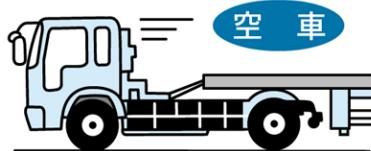
積載時と空車時では重量差が大きいことから、動力性能に大きな差を生ずる
