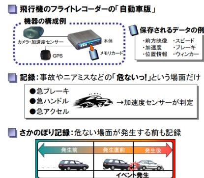
■ ドライブレコーダーの映像は、実際のトラック事故やヒヤリハットの実態がわからることから、具体的に「何が要因であったのか」「どのような状況であったのか」「運転者は何を見落としたのか」など、事故の危険性の要因を実際の映像で確認させることができます。また、デジタルタコグラフの運行記録などとあわせると、どこでスピードを出していたのか、ブレーキを踏んだのかなどがわかります。
