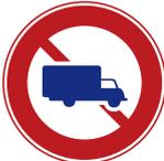
この標識の設置されている道路は、大型貨物自動車と特定中型貨物自動車、大型特殊自動車は通行止めであるが、車両総重量8t未満、最大積載量5t未満の貨物自動車は通行できる。
