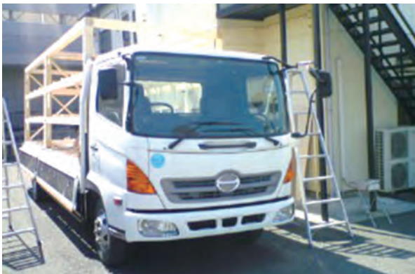
ご遺体搬送用に架装を施す専用トラック (走行中はシートを掛けて使用)
