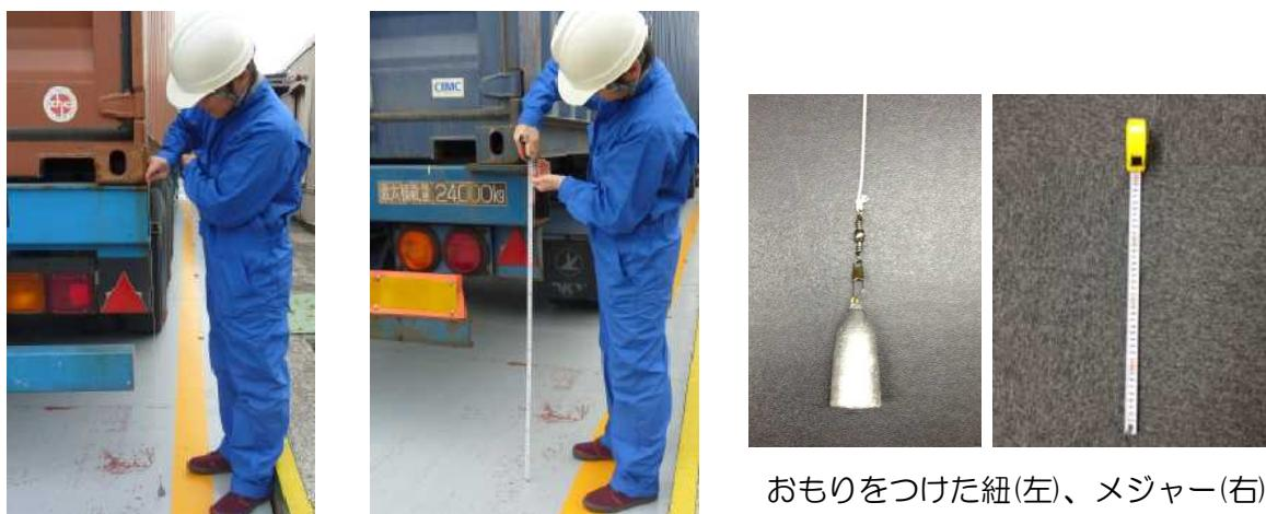
図 22 計測イメージと測定機材
