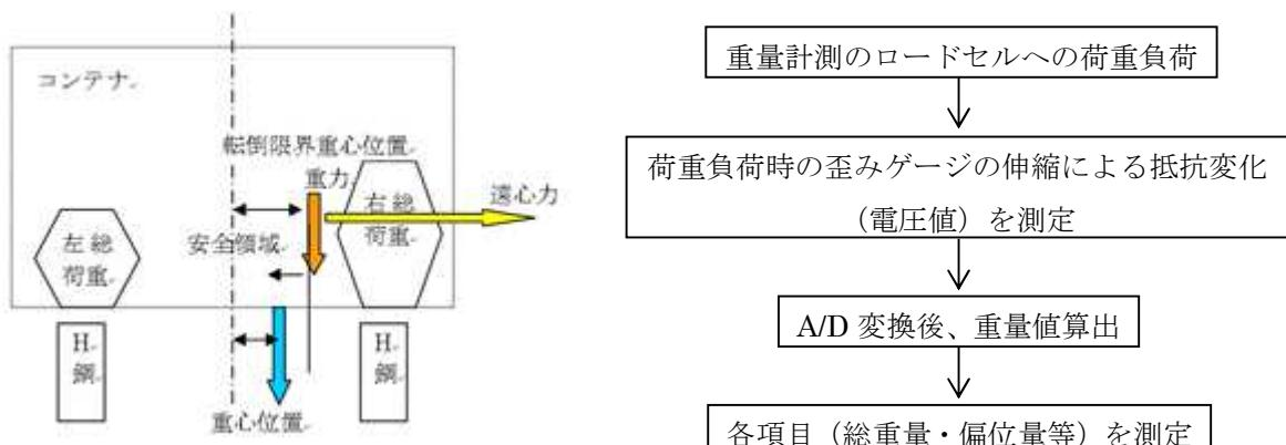
図38 総重量・偏加重測定の原理
