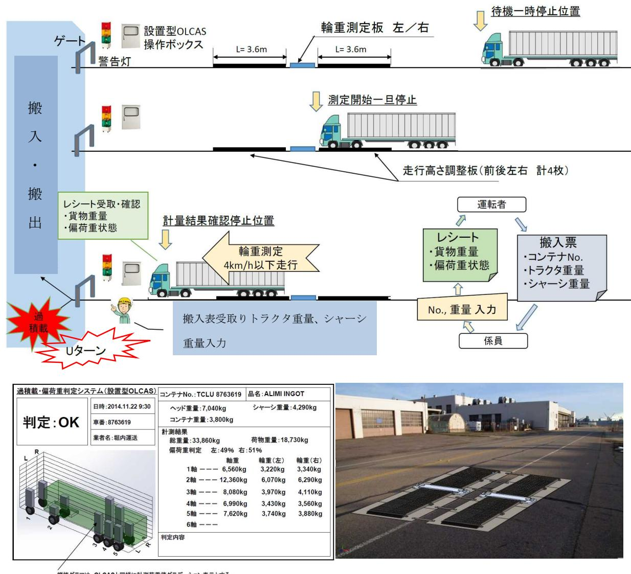
図45 路面設置型測定器の運用イメージ
