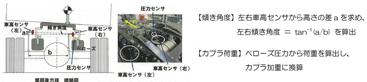
図36 左右傾きの検出原理
