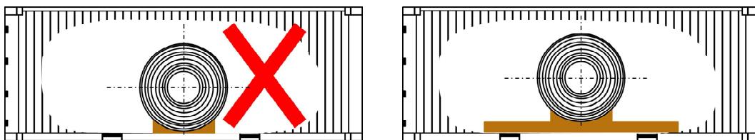
図24-1 積付の留意点（荷重を分散させる（右））
