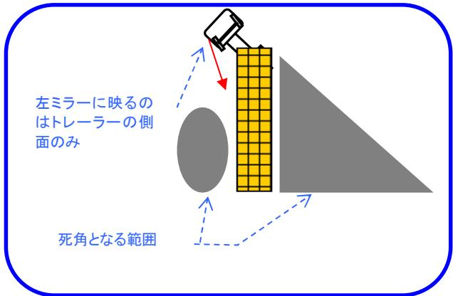
図 10 連結車の死角（左折旋回時）
