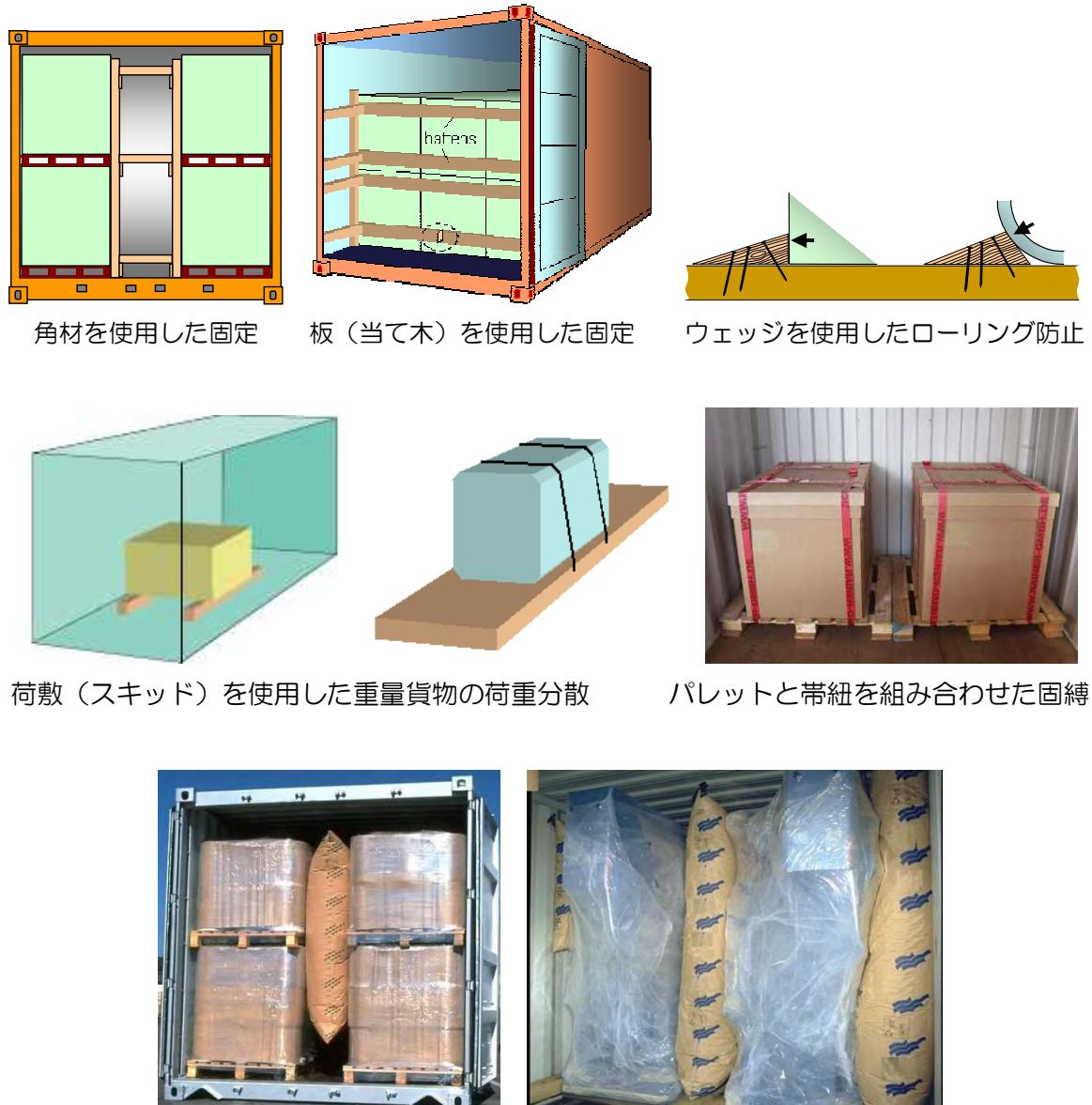
図31 荷敷・緩衝材（仕切り材）の使用例
