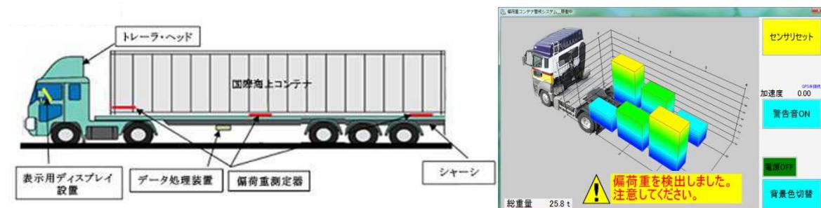
図37 荷重測定位置と表示モニタ
