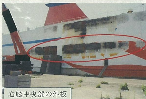
写真1 第2甲板右舷中央部の損傷状況
