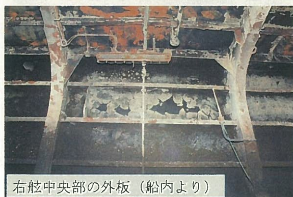
写真1 第2甲板右舷中央部の損傷状況
