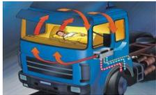
アイドリングストップ支援機器 (バッテリー式冷房装置)
