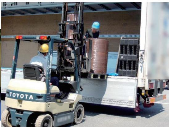
倉庫に横積み保管されている製品を、ラムフォークリフトで1本ずつトラックの荷台に積み付ける。
