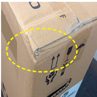
ケース④ 角のつぶれ
