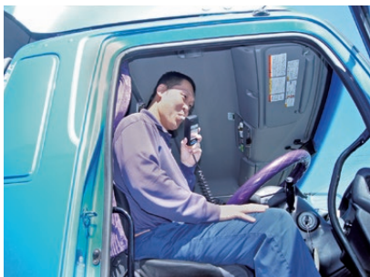
飲酒運転を防止するための呼気吹き込み式アルコールインターロック装置
