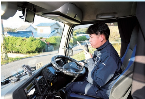
飲酒運転を防止するための呼気吹き込み式アルコールインターロック装置
