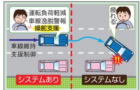
走行車線を認識し、車線維持に必要な運転者の操舵力を軽減します。何らかの理由で車線から逸脱しそうになった場合には、運転者が車線中央に戻す操作をするよう警報します。
