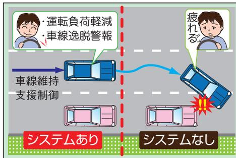
走行車線を認識し、車線から逸脱した場合あるいは逸脱しそうになった場合には、運転者が車線中央に戻す操作をするよう警報します。
