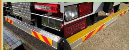
【リヤバンパ滑り止め工作】 縞板張り 滑り止めテープ張り
