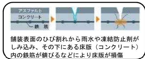
舗装表面のひび割れから雨水や凍結防止剤がしみ込み、その下にある床版（コンクリート）内の鉄筋が錆びるなどにより床版が損傷
