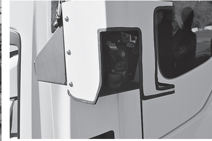
④LIDARセンサー下部にもカメラを設置。側方の車両も認識することで、後方から追越してくる車両の動きをとらえる
