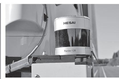
③レーザー光を使い、周辺車両や歩行者、建物、障害物などの対象物との距離や形状、位置関係を測定するLiDARセンサー。夜間でも対象物の検知が可能。現在は前方左右の2か所に設置されているが、後方左右にも設置することで自車の周囲を360度監視可能となる
