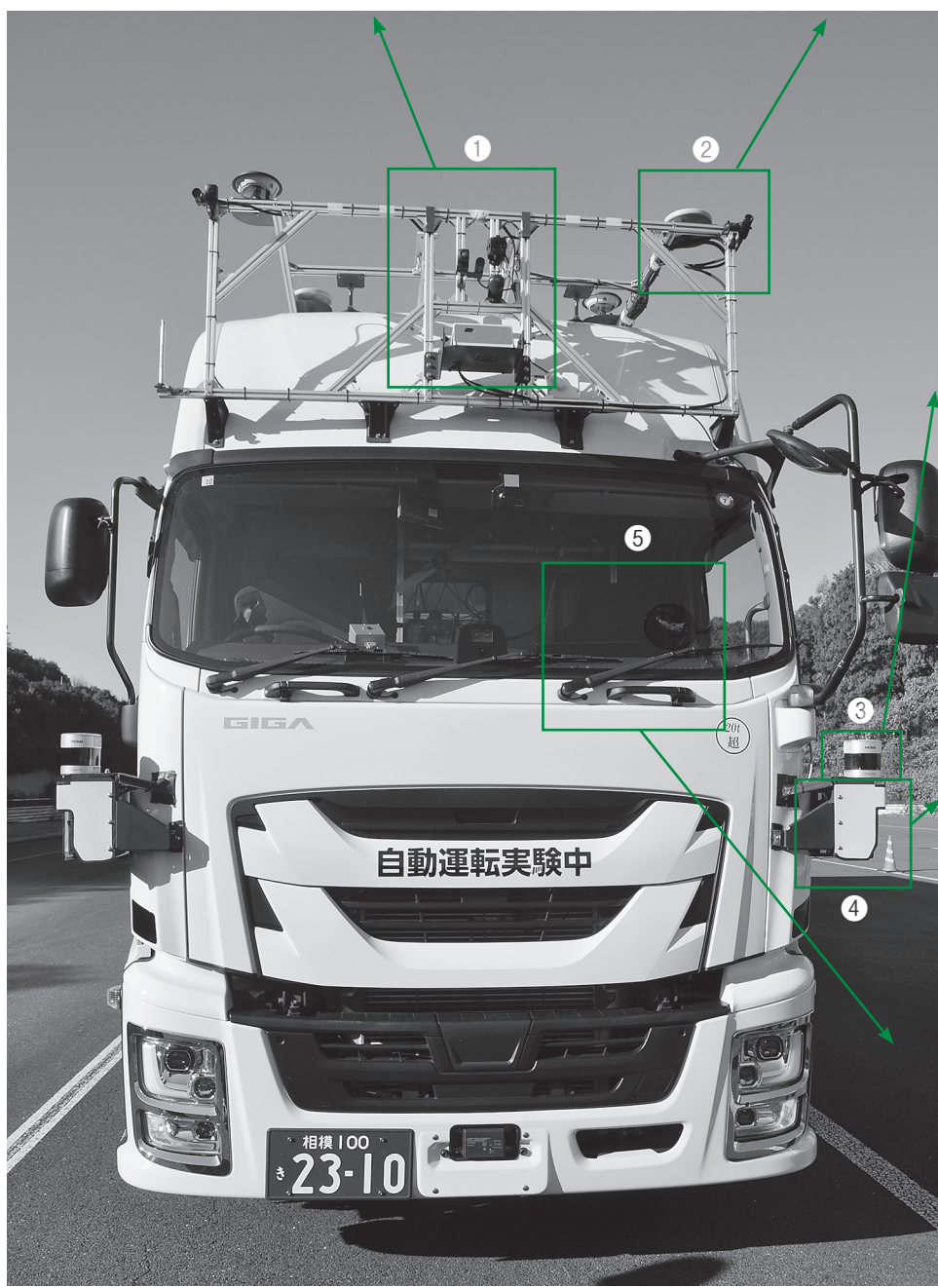
③レーザー光を使い、周辺車両や歩行者、建物、障害物などの対象物との距離や形状、位置関係を測定するLiDARセンサー。夜間でも対象物の検知が可能。現在は前方左右の2か所に設置されているが、後方左右にも設置することで自車の周囲を360度監視可能となる
