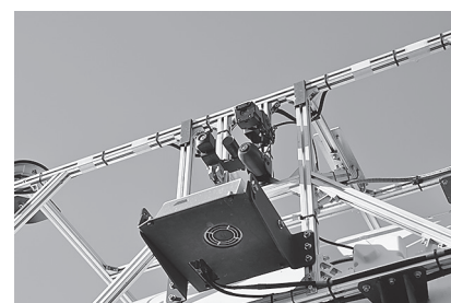
①前面上部に設置された複数台のカメラで、前方の道路上の白線や前方を走行する車両などの対象物を高精度で認識。近距離では、極めて高い精度で物体を認識することができる
